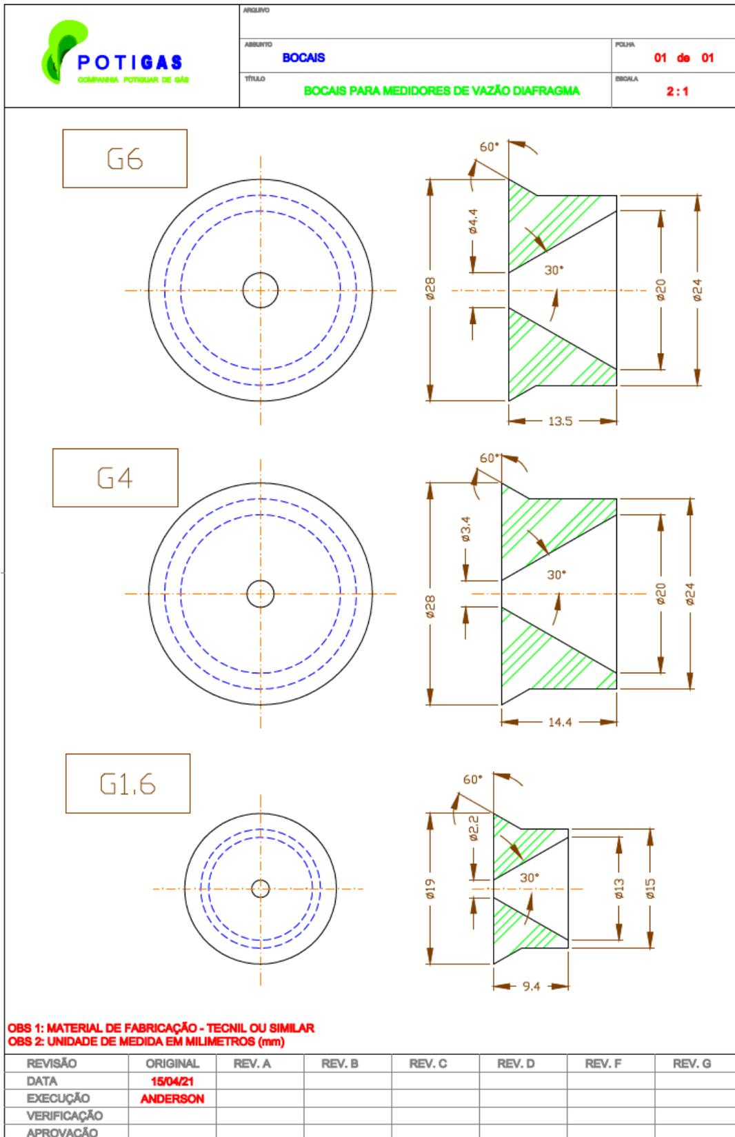
Figura 01 – Geometria dos bocais limitadores de vazão (restritores)
